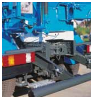
Подножка на заднем противоподкатном брус
