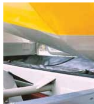
Защитное покрытие между лонжеронами рамы
